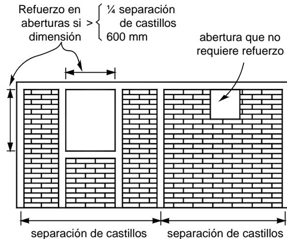
**Figura 5.3 Refuerzo en el perímetro de aberturas**
