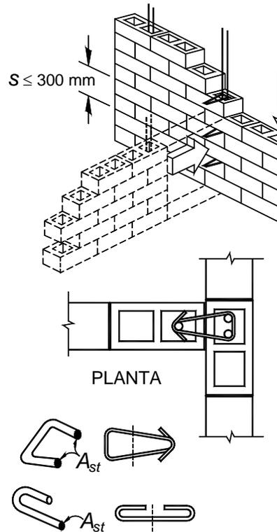
**Figura 6.2** Conectores entre muros sin traslape de piezas
