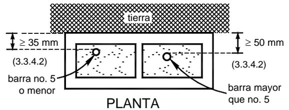
**Figura 3.8** Tamaño, colocación y protección del refuerzo
