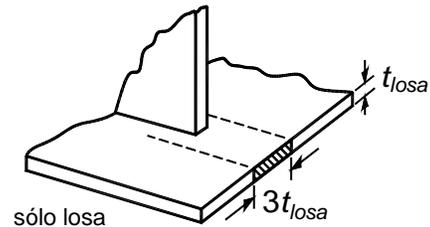
**Figura 3.4 Ancho equivalente en losas**
